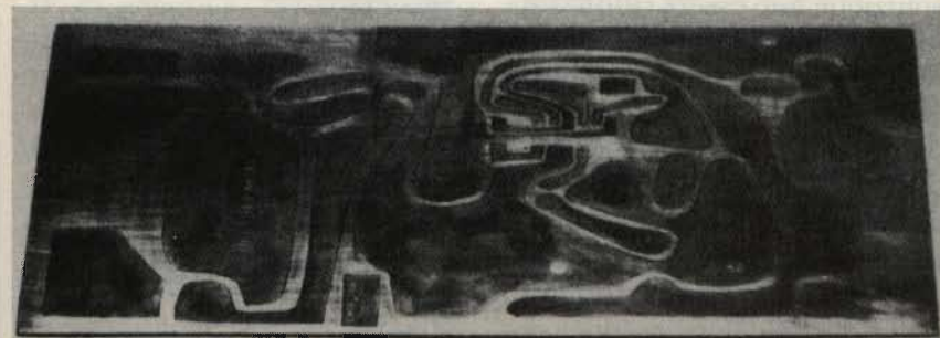
Foto E. Staccata la carta residua, resta visibile il tracciato delle piste, protette dal resist.
