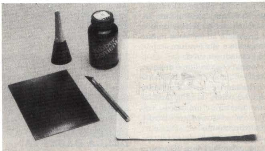
Foto A. I materiali necessari: laminato in bakelite o vetronite, smalto per unghie, colla alla gomma, un coltellino ben affilato e, naturalmente, il tracciato delle piste.
